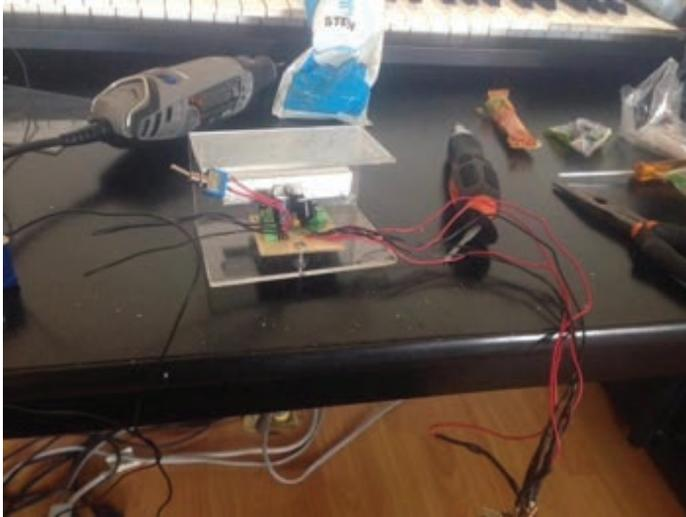
9.-Una vez lista la placa, se fija a una caja de acrílico para aislarla de la mochila en la cual se incorporará.
